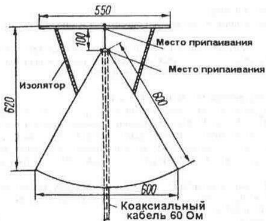
Рис. 12. 34. Дisko-конусная антенна на диапазон 85...500 Мгц
